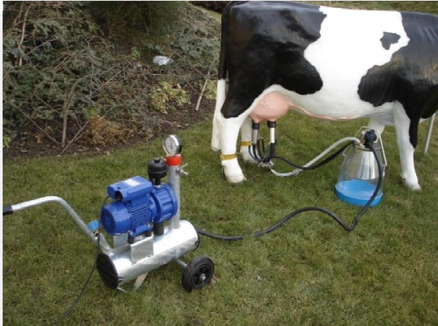
Die Mobil-Milker BERA Baby1 & Baby2 sind komplett mit Vakuumtank, Regelventil und Vakuumanschlüssen.
