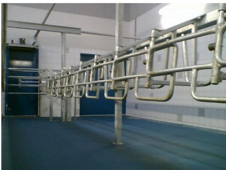
Die Kühe kommen hintereinander in den Melkstand hinein. Sobald die erste Kuh sich im ersten Standplatz positioniert hat, öffnet sich ein Zugang, sodass die zweite Kuh sich in den Melkstand begeben kann, usw. Die kurzen Lauflinien tragen zu einer hohen Wechselkapazität bei. Die Tore sind federlos und schliessen sich durch die einzigartige Konstruktion reibungs- und geräuschlos. Ausserdem ermöglichen die Tore das Melken in einem nur teilweise gefüllten Melkstand.
